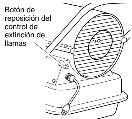
Figura 6 - Botón de reposición del control de extinción de llamas, modelo de 29,3/44 kW (100.000/150.000 Btu/hr)
